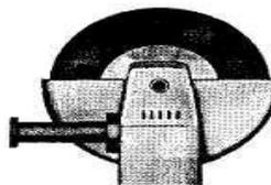
Запрещается работать без предохранительного кожуха
