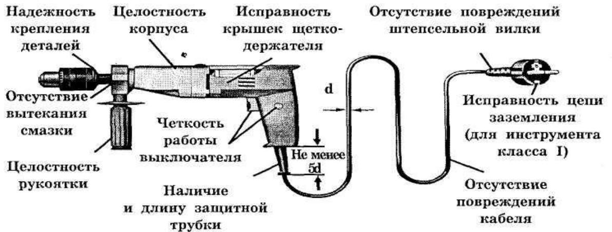
2.4. При несоответствии хотя бы одного из перечисленных в п. 2.3 настоящей инструкции требований электроинструмент не выдается (не принимается) для работы.
